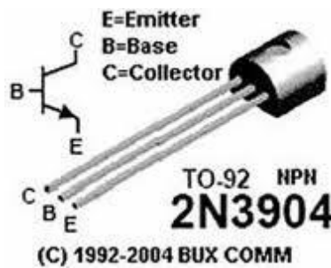
Fig. 23.- Esquema eléctrico Sensor 2N3904. Trabajo experimental 2015
