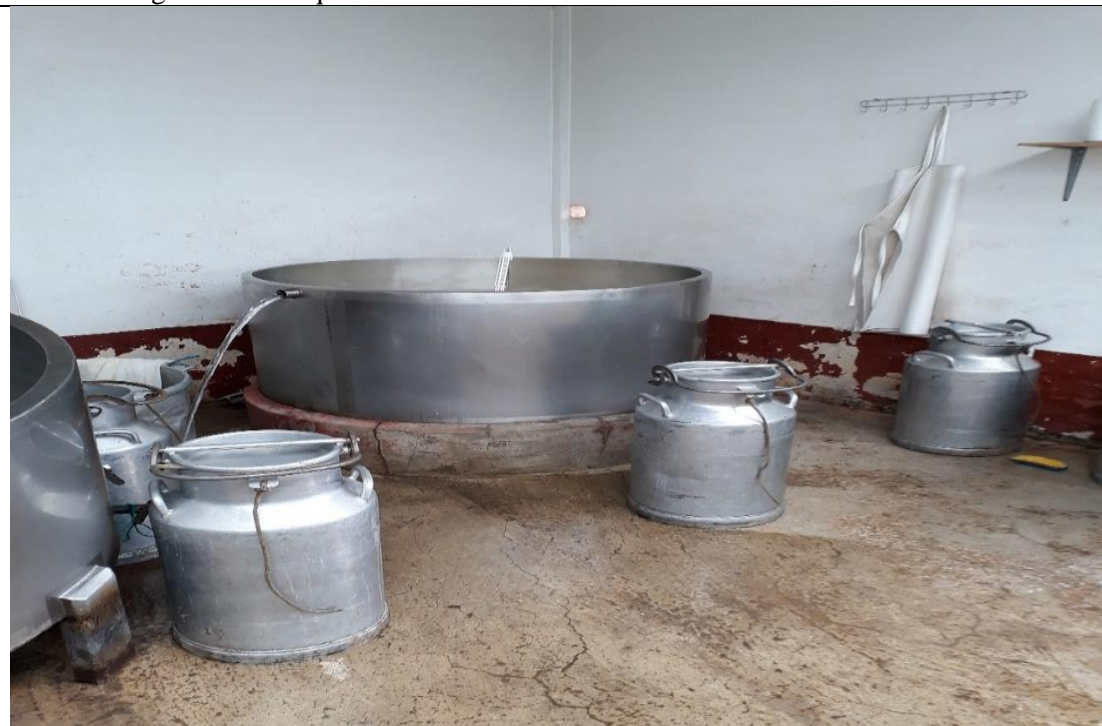
Olla de acero inoxidable para la elaboración de quesos
