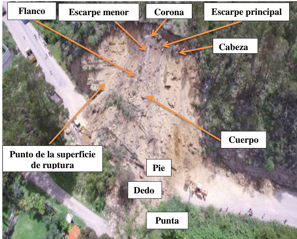
Grafico 1: Partes de un deslizamiento
