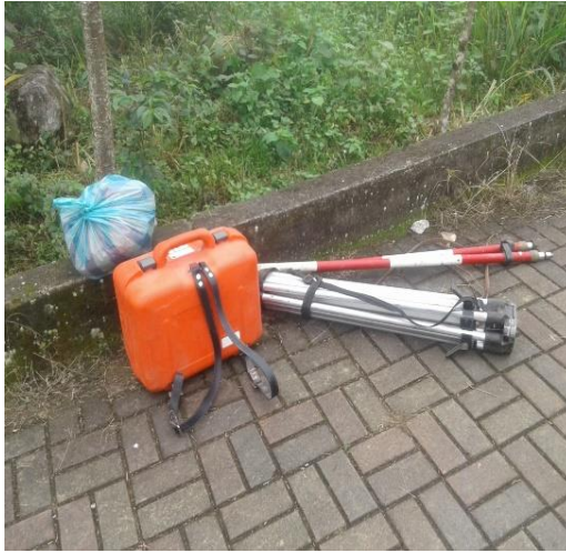
Foto 1 Equipo estación total, teodolito y prisma.
