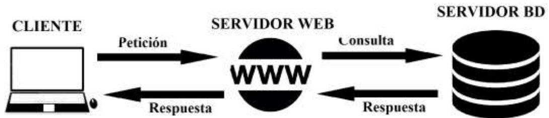
Ilustración N° 29. Arquitectura del Sistema Cliente – Servidor modelo de tres capas.
