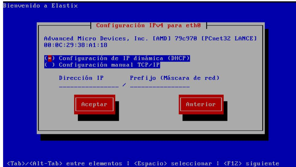
Figura 5.8 Configuración IPv4 para eth0
