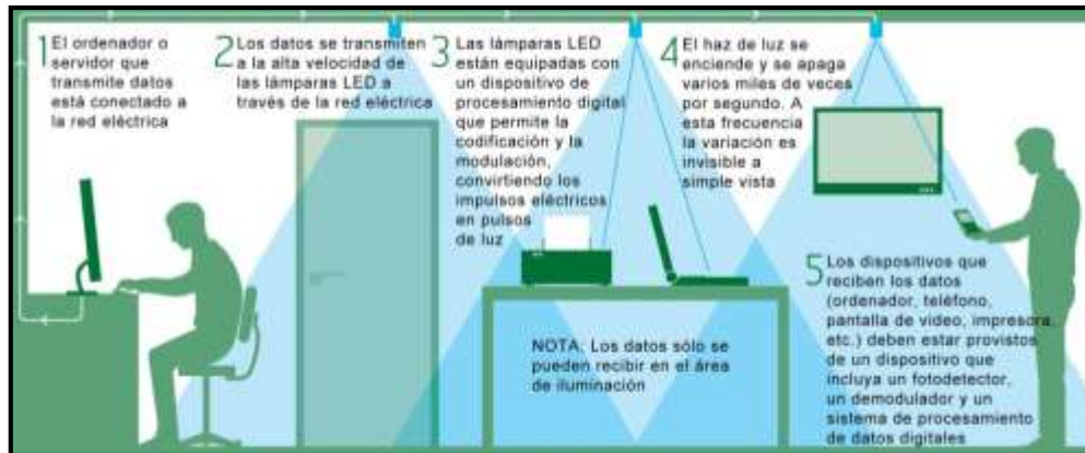
Figura 3: Funcionamiento de Lifi
