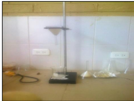
Imagen N°15: Filtración de cafeína a través de papel filtro
