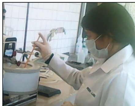
Imagen 16: Evaporación de la solución acuosa para obtener en polvo.
