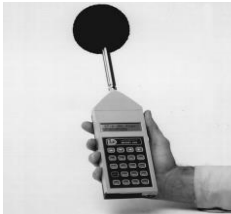
Gráfico N° 8 Sonómetro, con guarda viento.
