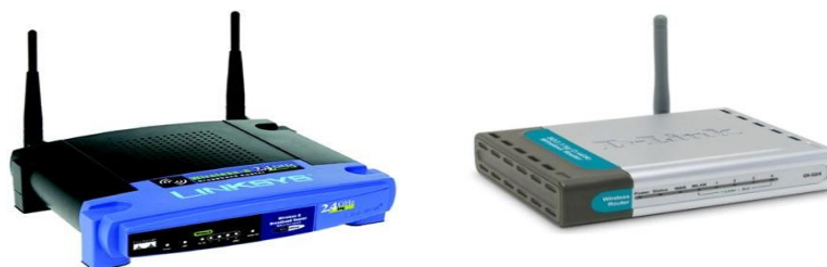
Fig. 1.31 Puntos de Acceso (Access Point)
