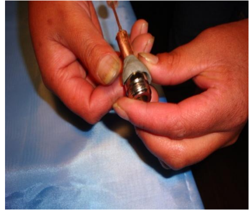
Fig. 2.57 Colocación de la masilla epóxica
