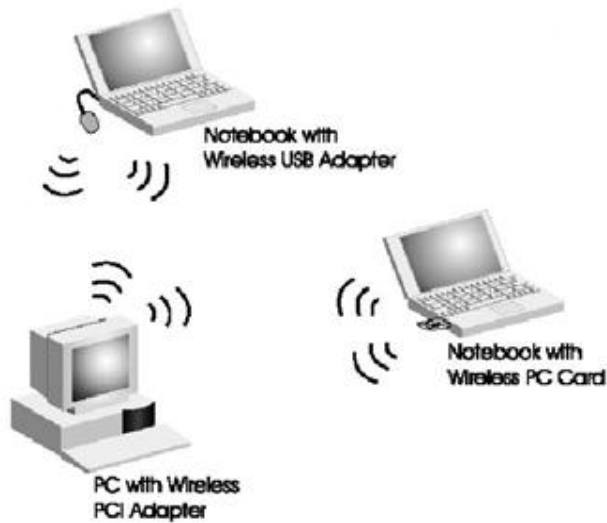
Fig. 1.55 Topología Ad-hoc o Peer to Peer
