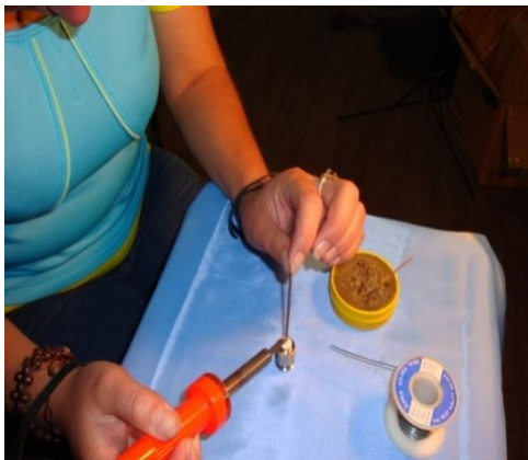
Fig. 2.50 El segmento de 6,15 cm soldado al pin del conector
