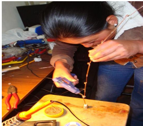
Fig. 2.55 Relleno de bobinas
