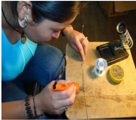
Fig. 2.54 Los ocho segmentos soldados en serie
