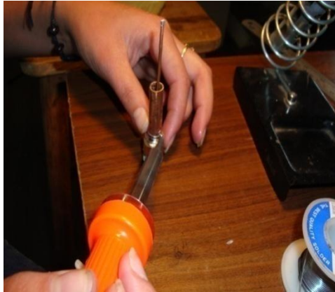
Fig. 2.51 La cañería de 3 cm soldada a la base negativa del conector Fuente: Creación propia.
