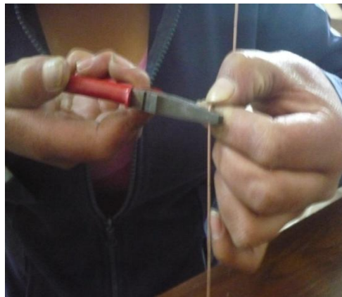
Fig. 2.19 Hacer un dobléz de 90° Fuente: Creación propia
