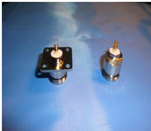
Fig. 2.48 Conector N chasis normal y limado
