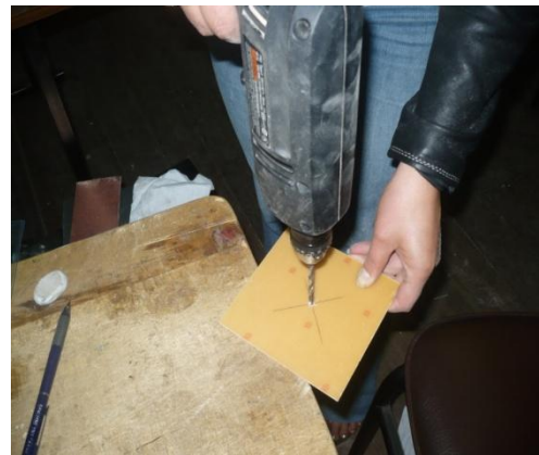
Fig. 2.12 Hacer el agujero en la baquelita Fuente: Creación propia
