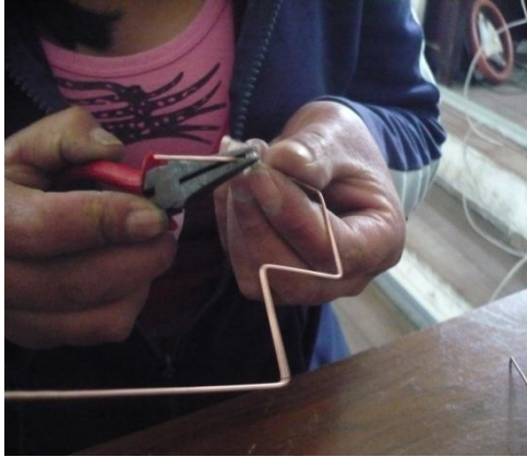
Fig. 2.21 Doblez de 90^\circ al cable Fuente: Creación propia
