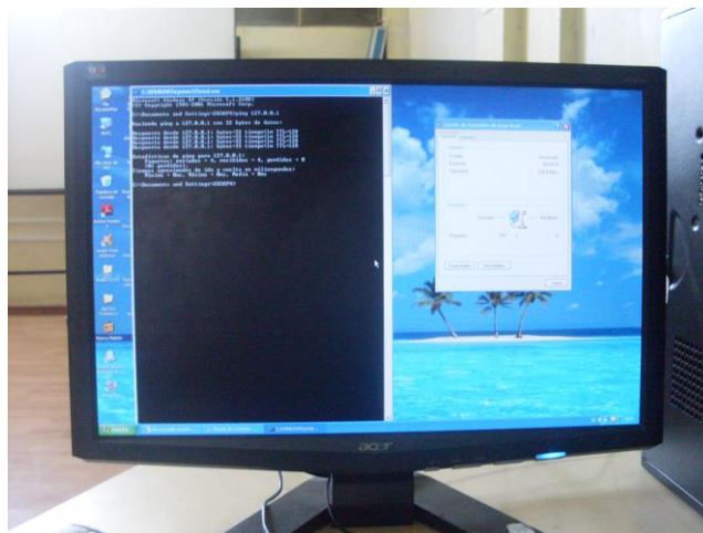
(Fig 29) Revisión del funcionamiento de la tarjeta de red
