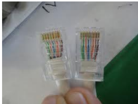
(Fig.25) Tope de los cables al RJ-45
