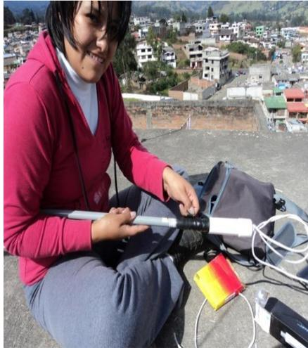
Fig. 2.53 Bullet2 y antena omnidireccional con cinta autofundente
