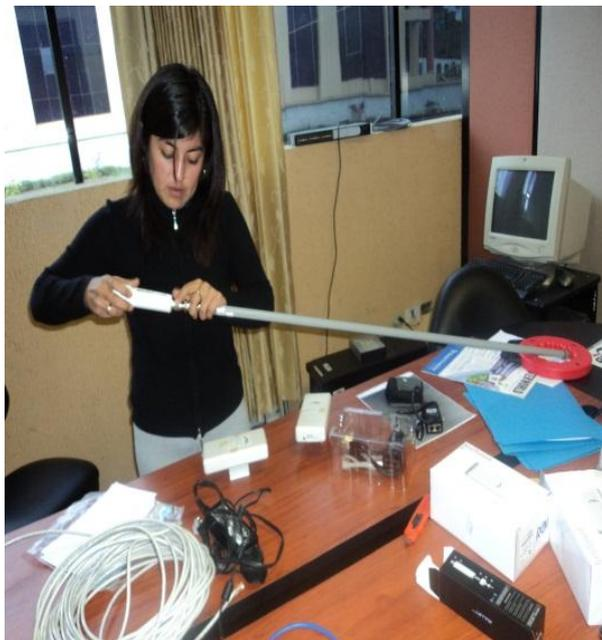
Fig. 2.32 Conexión del Bullet2 a la antena omnidireccional
