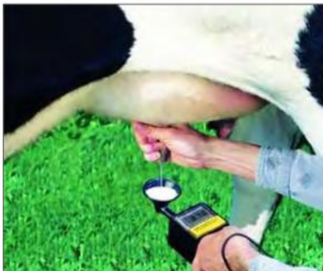
Figura 10. Aparato para determinar la conductividad eléctrica de la leche.
