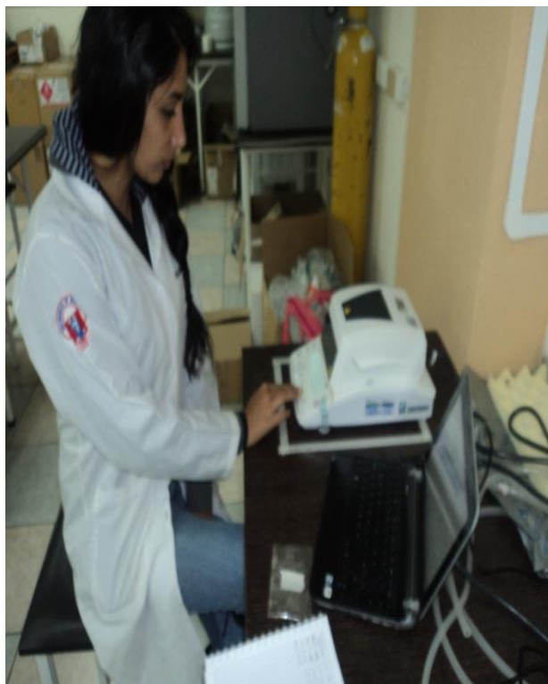
Determinación de humedad (Analizador de luz halógena)
