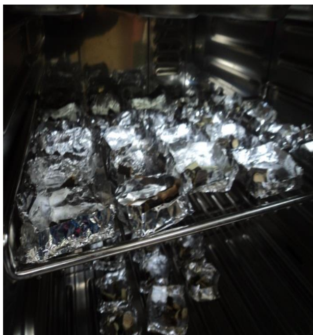
Contraste de la humedad por el metodo de Estufa a 105°C
