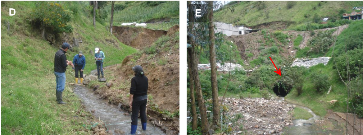
Foto 8.- Arroyo principal de la zona de estudio. A: Medida de caudal en el afloramiento de agua. B: Cascada en la parte baja de la quebrada. C: Confluencia con el río Yanayacu a través de pequeño embaulado. D: Aforo del río Yanayacu. E: Entrada del río Yanayacu al embaulado que discurre bajo la población de San José de Chimbo.
